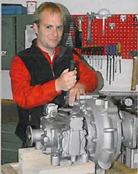
Die Feuerlöschkreispumpen baut Firma Hale für Lentner. In Hohenlinden werden sie dann komplettiert und den Kundenwünschen angepasst.
