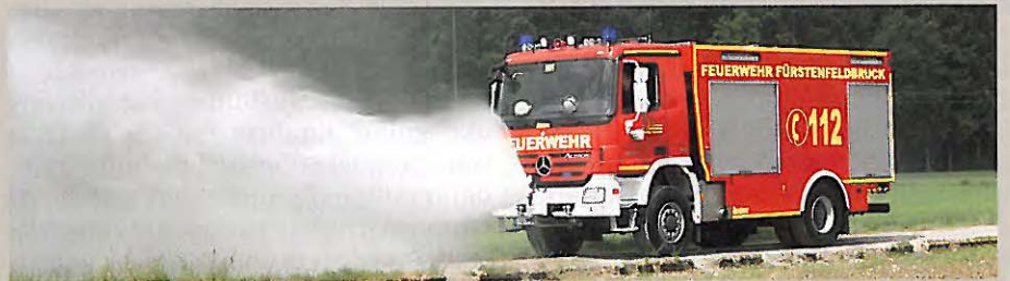
Maximal 600 Liter Wasser können über den Alco-Frontmonitor des TLF 20/40 SL der FF Fürstenfeldbruck pro Minute abgegeben werden. Als Fahrgestell dient ein Mercedes 1841 AK.
